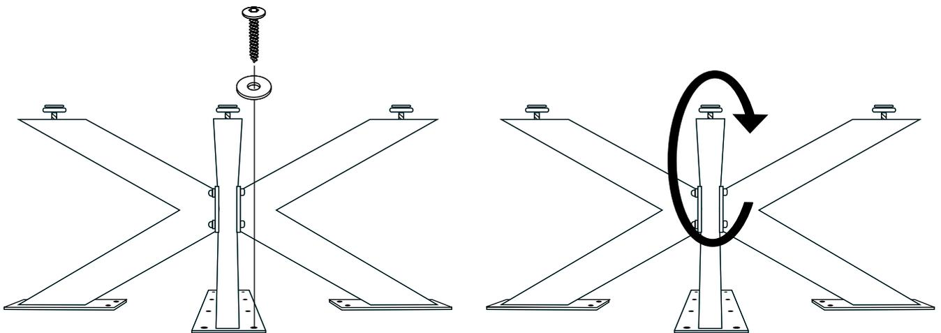
**Schritt 5** Bereit für die Montage der Tischplatte: Die mitgelieferten Schrauben in die vorgebohrten Löcher schrauben.
