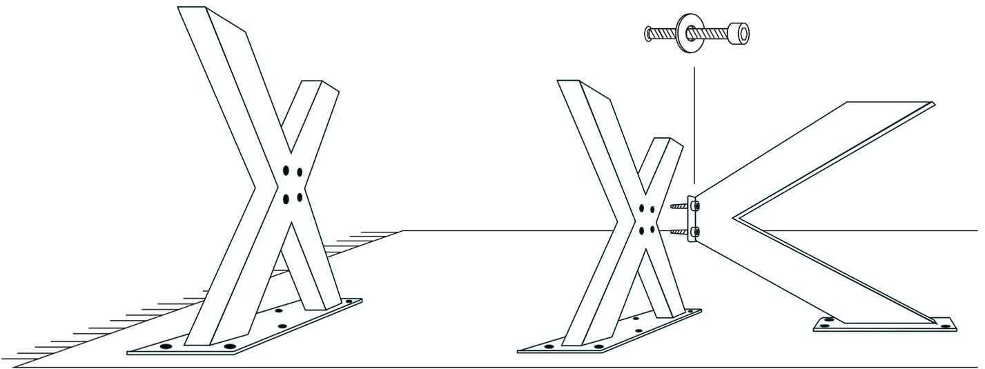
**Schritt 1** Aufbau mit Unterlage empfohlen, Einzelteil X umgedreht aufstellen.
