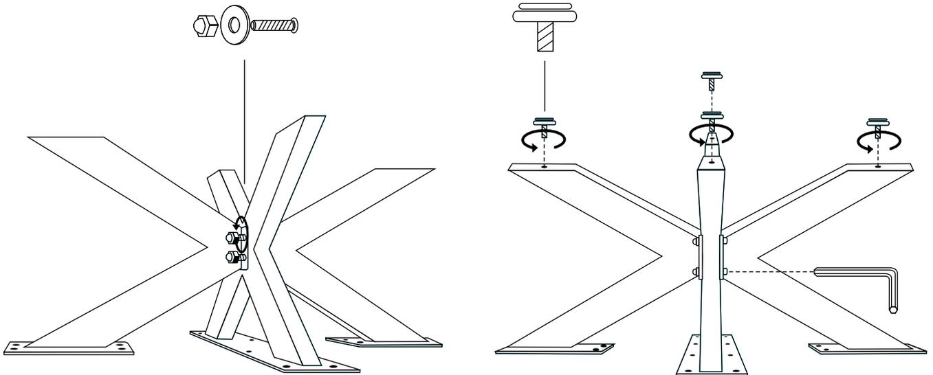
**Schritt 3** Zweiten Seitenfuß umdrehen, Teile verbinden, Hutmuttern locker anschrauben.
